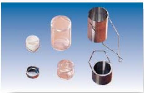
Камера для экспериментов в печи (диаметр 18 мм) адаптирована для использования разных тиглей, в зависимости от диапазона температур, массы анализируемого образца и типа воспроизводимой реакции. Эти тигли состоят из разных материалов и имеют разные объемы:
