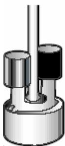
В защищенном датчике-подвеске ДТА измерительные или контрольные термопары покрыты тиглями. Они более защищены в случае, если из образца выделяется агрессивный пар.
