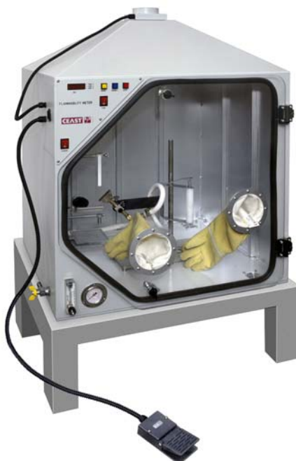
Стенд для определения воспламеняемости фирмы ЧЕАСТ согласно UL94
