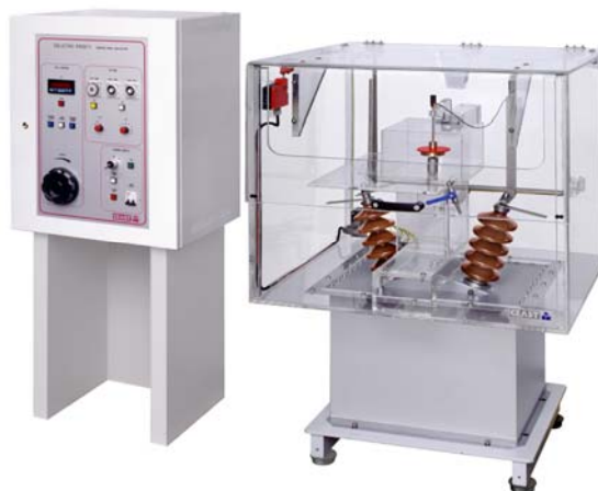
Лабораторная установка фирмы ЧЕАСТ для измерения электрической прочности
