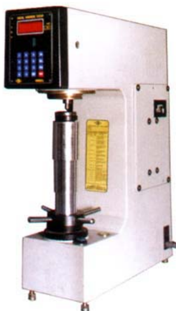
Лабораторный тестер твердости по Роквеллу. Фирма CEAST.
