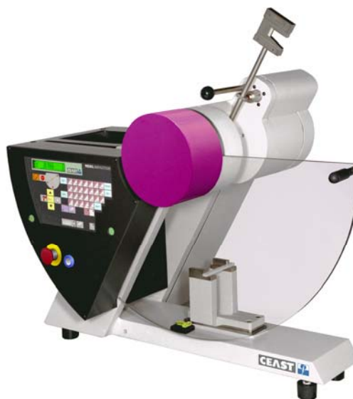
Метод измерения ударной прочности по Шарпи и прибор для ее измерения фирмы CEAST.
