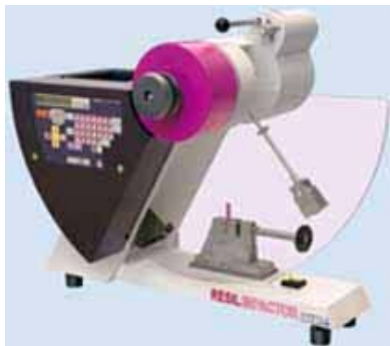
Маятниковый копер для измерения ударной прочности по Изоду. Фирма CEAST.
