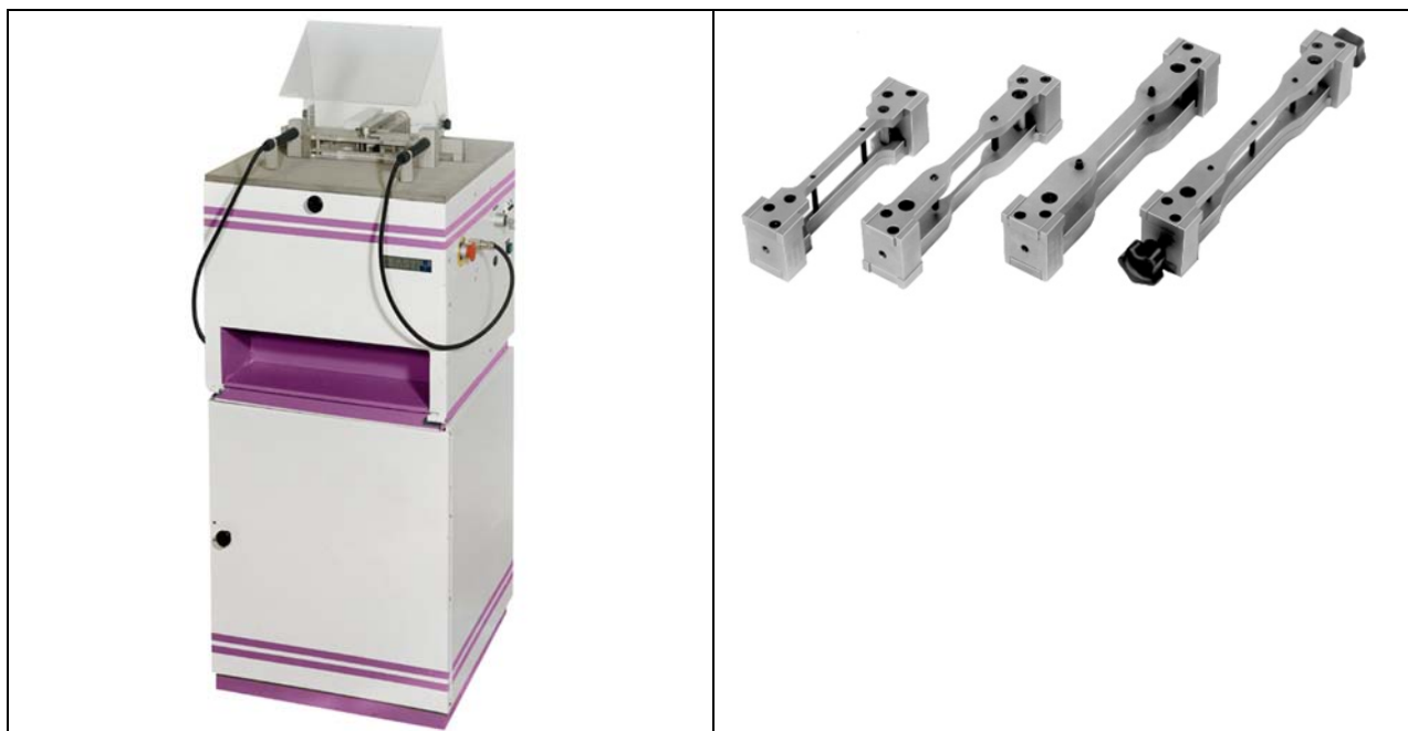
Рис. Специализированный фрезерный станок с пантографом фирмы CEAST. Мастер платы.
