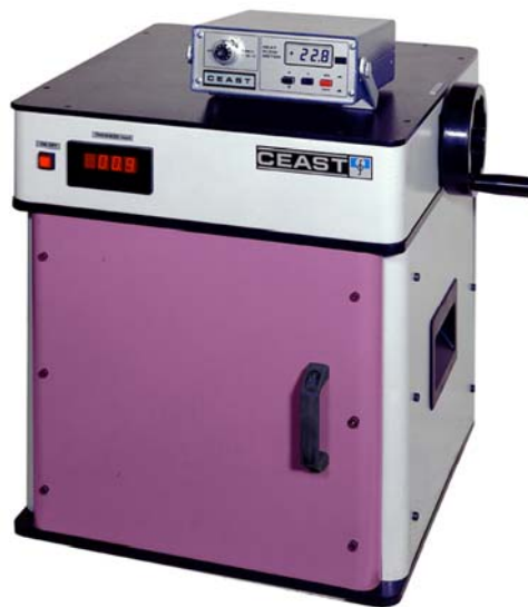
Прибор для определения теплопроводности вспененных материалов. Фирма CEAST.
