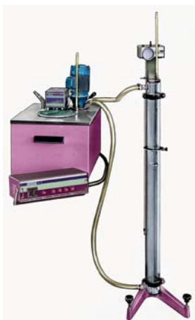
Градиентная колонка для определения плотности полимеров фирмы ЧЕАСТ
