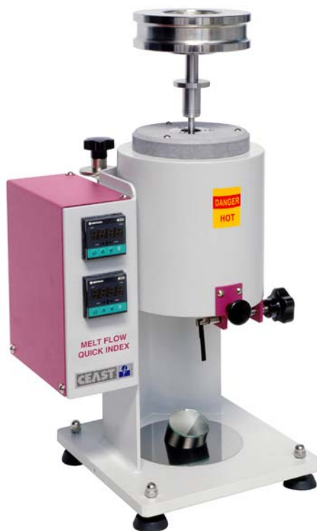
Лабораторный прибор для измерения индекса расплава фирмы ЧЕАСТ, модель MFQ1.
