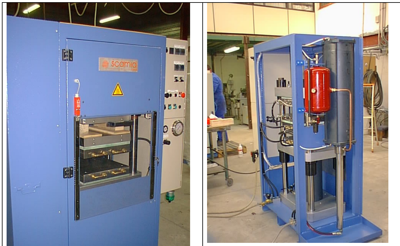
Пневмогидравлический пресс фирмы SCAMEX с усилием 60 т, размеры плит 60х60 см. Точность поддержания температуры до \pm 1^{\circ}\text{C}
