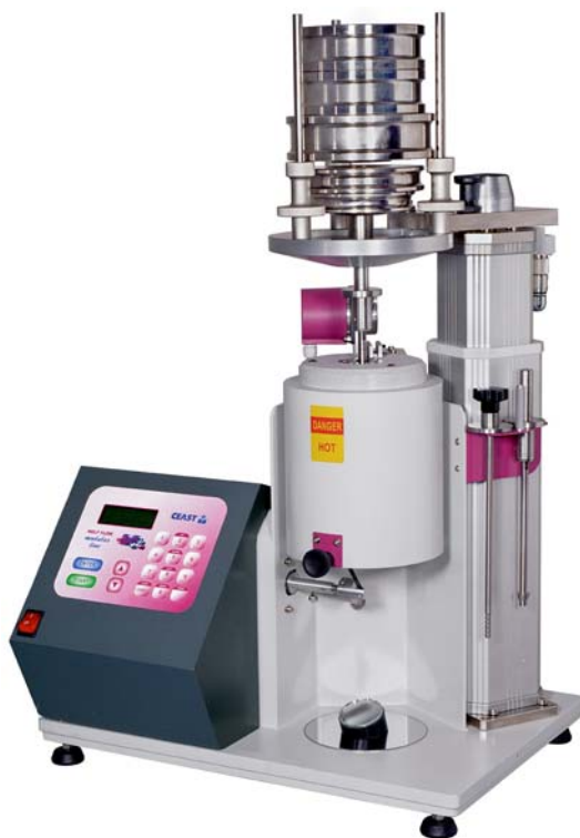
Прибор для определения ПТР по методу А и В фирмы ЧЕАСТ. Нагрузка может меняться во время испытания.
