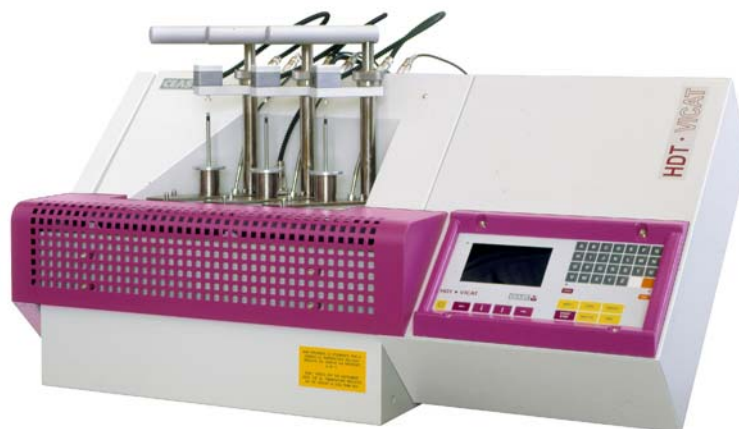
Прибор HDT/VICAT для определения теплостойкости фирмы CEAST.
